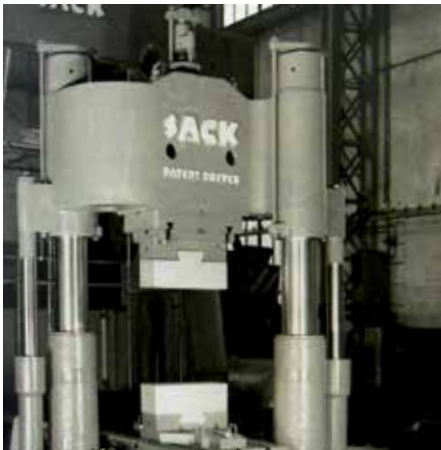
1956: Die erste unter der Leitung von Hans-Joachim Pahnke gebaute Freiformschmiedepresse mit 10 MN Presskraft. Konstruiert wurde sie in Unterflurbauweise mit Z-förmigen Querhäuptern.
