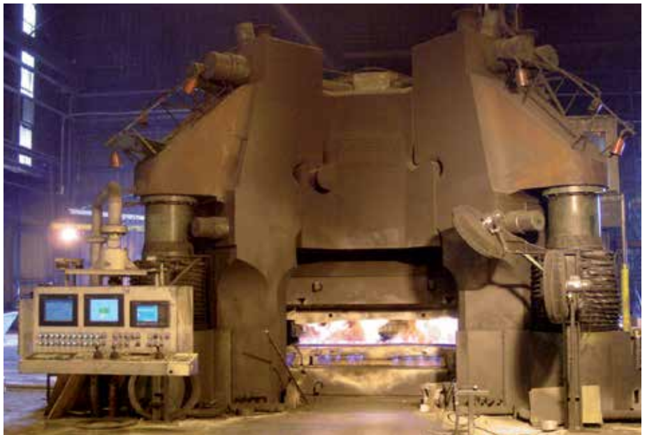
Diese leistungsstarke Gesenkschmiedepresse mit einer Presskraft von 300/350 MN ist bei Weber Metals, Inc. in den USA, im Einsatz.
