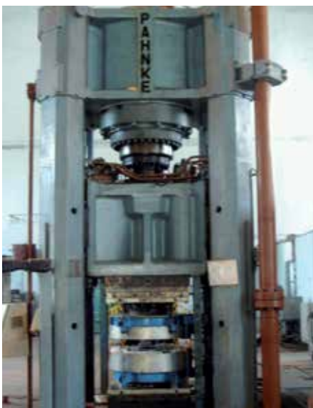
Ein Beispiel aus dem Portfolio von Wepuko PAHNKE ist diese 20 MN Multifunktionspresse mit Kraftstufen von 15 und 6 MN mit eingebauten Isotherm-Schmiedewerkzeugen.
