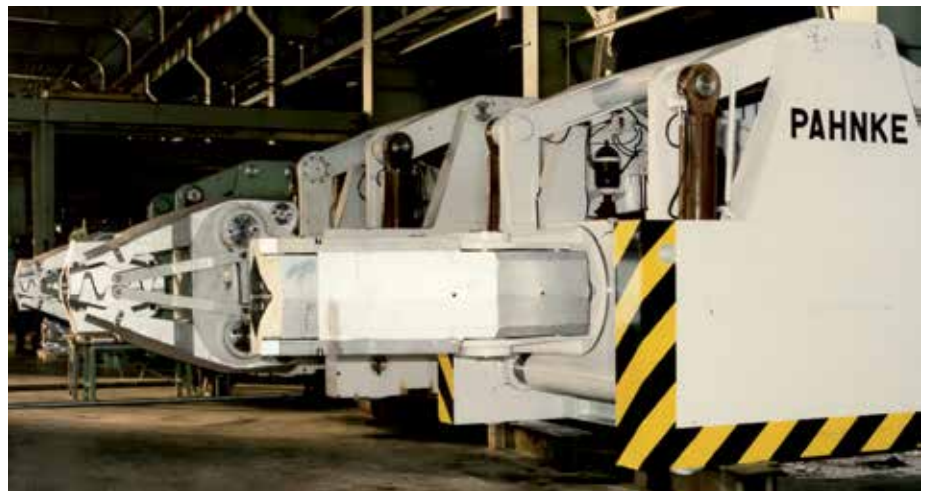
Schmiedemanipulatoren von Wepuko PAHNKE ermöglichen die schnelle und genaue Positionierung auch schwerer Werkstücke.
