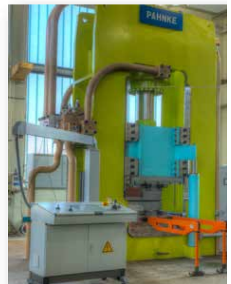
Diese besonders variable Multifunktionspresse mit 10 MN ist an der Technischen Universität Freiberg im Einsatz.
