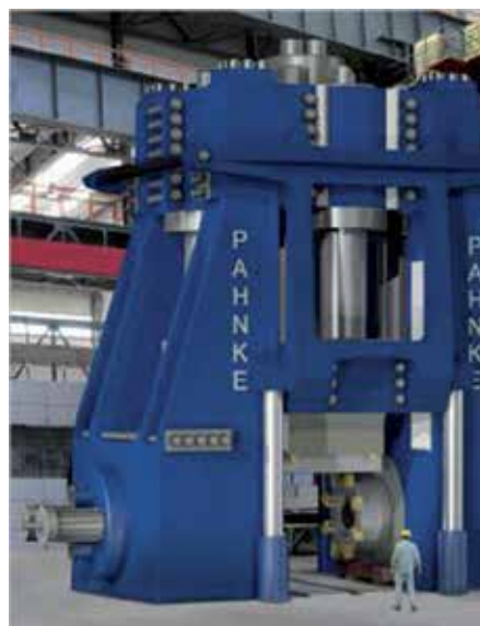
Diese 200 MN Mehrzylinderpresse fertigt geschmiedete Ventilkörper, die bei der Erdöl- und Gasförderung eingesetzt werden.
