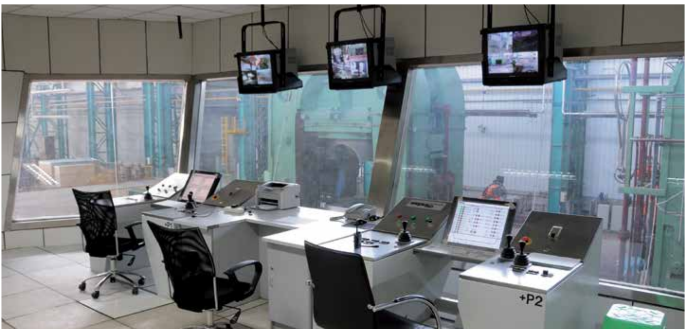
Steuerung für eine 360 MN Stahlstrangpresse und eine 150 MN Vorformpresse.
