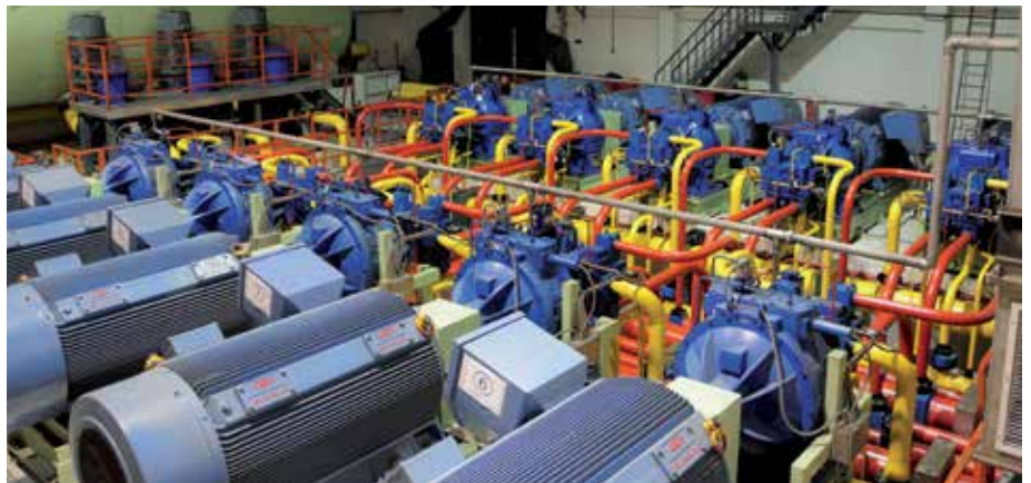
Ausschnitt eines 20-Pumpen-PMSD-Antriebes (RX 500) einer 185 MN Presse.
