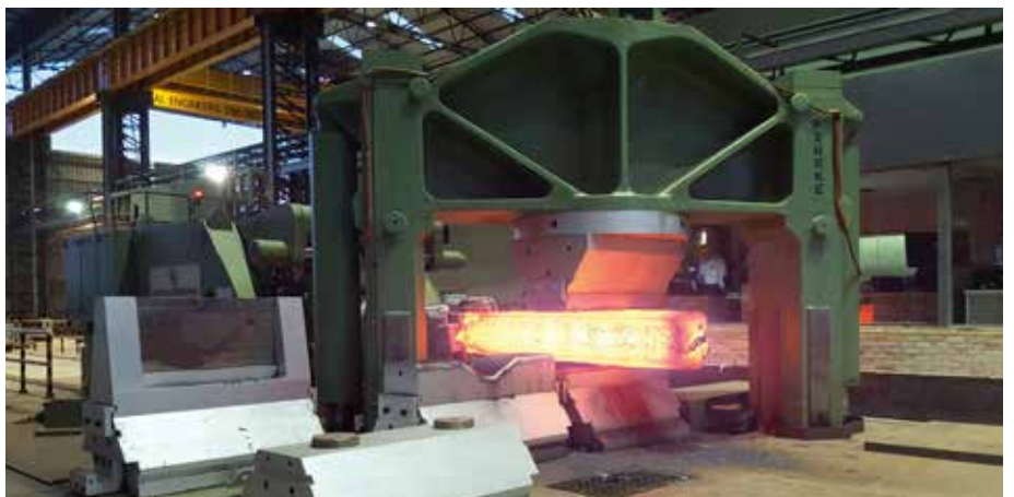
2017: Eine 31,5/38 MN Unterflur-Freiformschmiedepresse von PAHNKE bei CHW Forge in Indien. Die Presse besitzt einen PMSD-Antrieb mit 6 RX-Pumpen.
