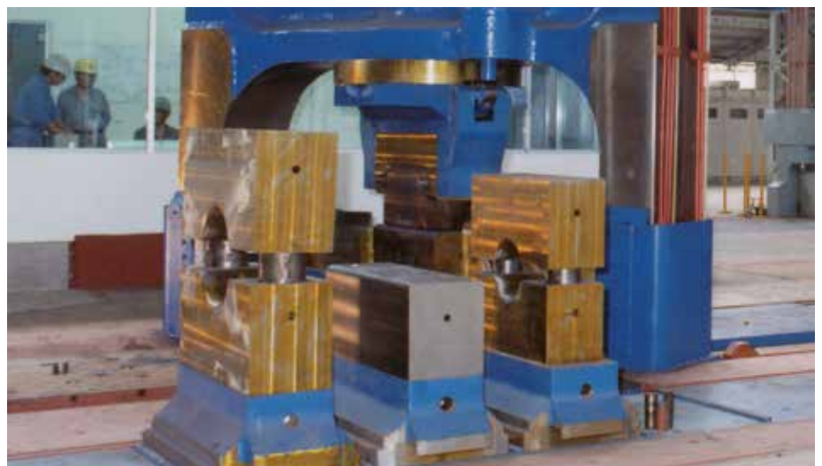
Werkzeugschnellwechselsystem einer 19 MN Freiformschmiedepresse.
