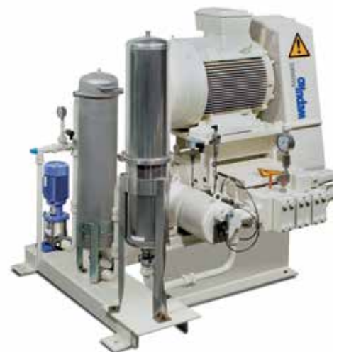
Pumpenaggregat DP405 für die Werkzeugkühlung in kompakter Ausführung inklusive Boosterpumpe und Filtern (saugseitig) sowie Resonator zur Druckpulsationsdämpfung (druckseitig).
