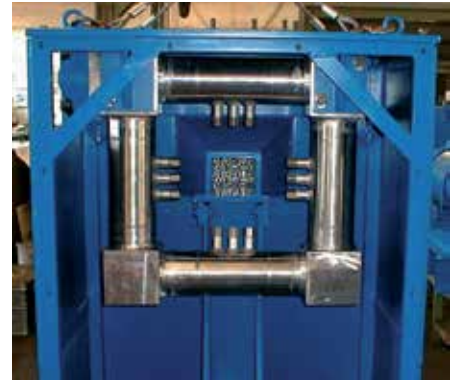
Spritzkabinen mit Spritzring für die Entzunderung von Knüppeln.
