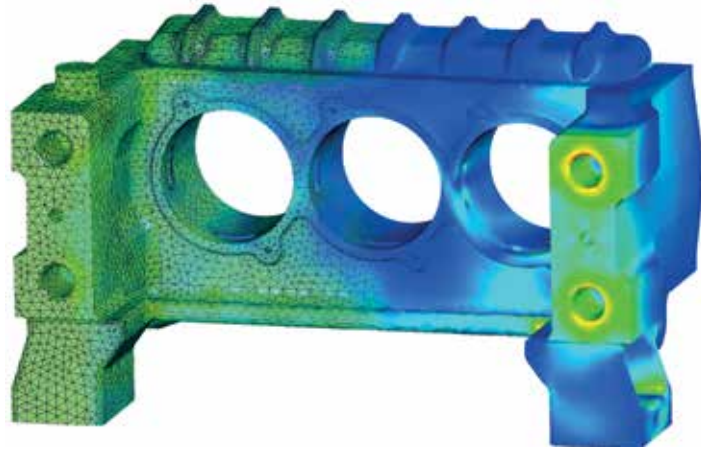
Konstruktionsbegleitend kommen bei Wepuko PAHNKE moderne Simulationstools wie FEM und CFD zum Einsatz.
