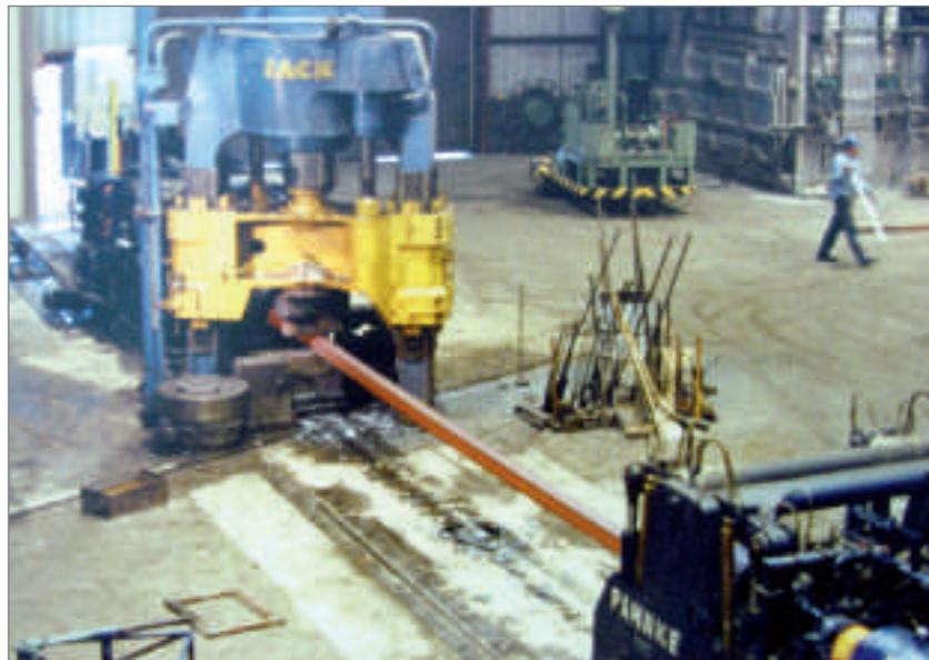
Projekt von Michael Pahnke bei PSI (1979): PMSD-Antrieb, zwei Manipulatoren und neue Steuerung für eine 7 MN Presse bei Press Forge Co.
