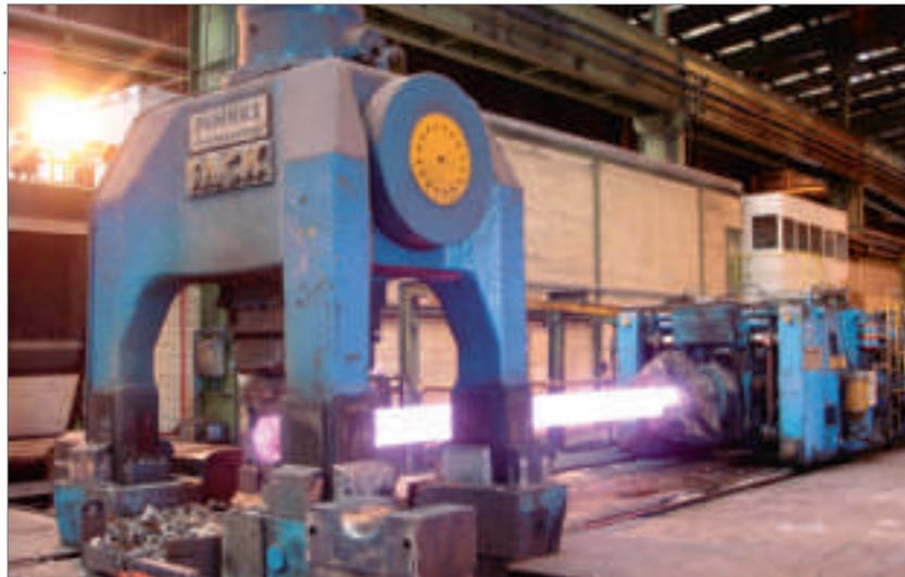
Dieses Vier-Quadratsäulen-Doppelrahmen-Konzept bot einen sehr stabilen, verbiegeungssteifen Rahmen. Die Rückmeldungen bezüglich der auswechselbaren Schleifleisten mit den nachstellbaren Flach-Führungen waren dementsprechend hervorragend.
