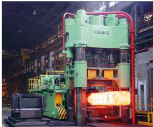
Villares Metals 30 MN (modernisation)
